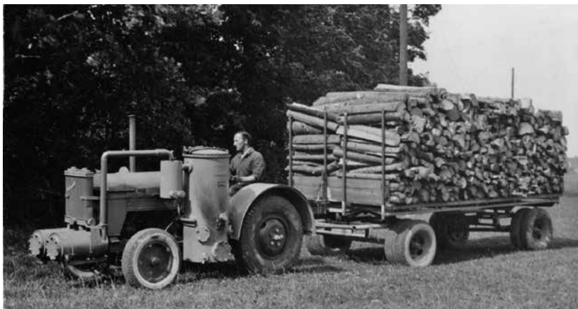
Stora mängder ved gick åt vid tegelbruken. Här en Wuco traktor med släp från samma företag. Gengasdrift från Imbert. Traktormotorerna kom företrädesvis från Fords A-modell. Foto: Okänd (Tekniska museet)
