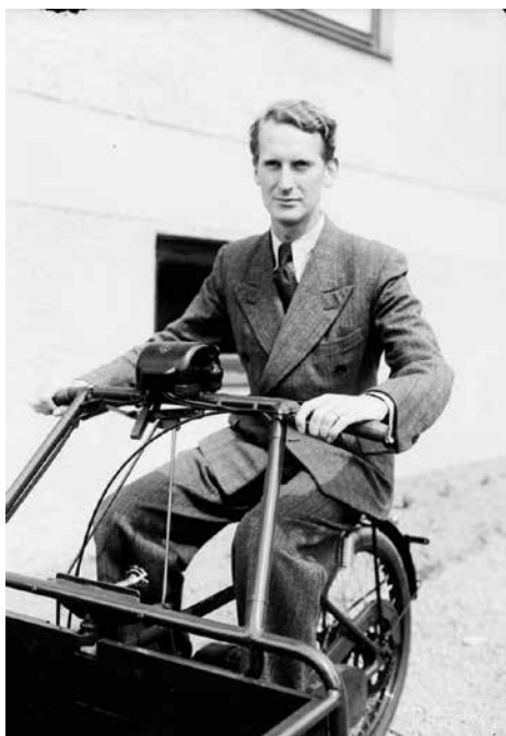
Försäljning av trehjuliga transportcyklar med eldrift, 1941 - 1942. Fordonet hade en räckvidd på ca. 30 km och en maxhastighet på 30 km/h Kanske var Wulf 75 år före sin tid. Den blivande försäljningschefen Sven Lind demonstrerar fordonet. Foto: Viktor Törnberg (Vänersborgs museum)
