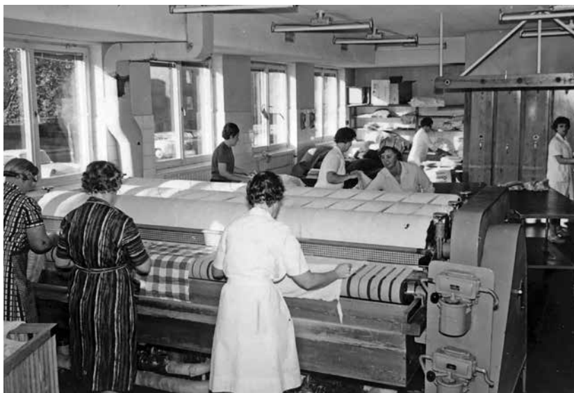
Den ånguppvärmda varmmangeln med tre valsar.
