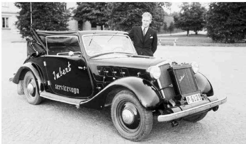
Imbert gasgenerator är monterad på servicebilen, en Hansa 1100.
