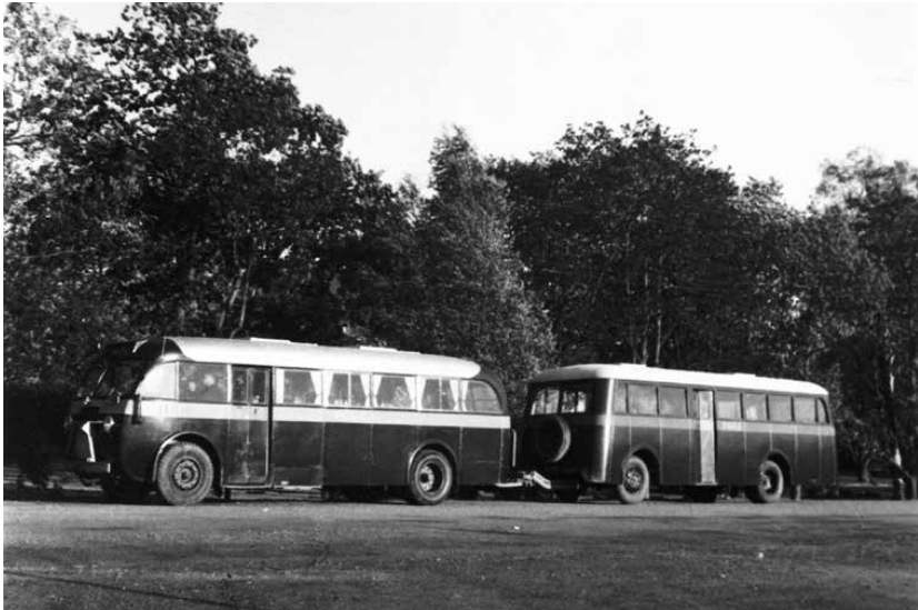
Dragvagnen från Scania Vabis, Wuco släp med Tor eller Hägglunds kaross. Släpvagnsbussen kunde ta 34 passagerare, den hade konduktör som också hade till uppgift att elda i vagnens kamin under vintertid. Foto: Okänd 1950. (Sörmlands museum)
