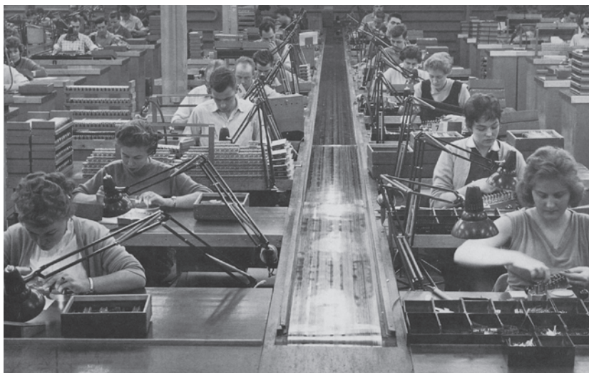
Materialtransportband för tillverkning och provning av reläer infördes som en tillämpning av modern produktionsteknik. Operatörerna styrde själva materialflödet.
