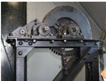
Genom denna anordning kan bron manövreras med handkraft.
